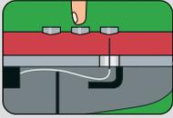
LOS MECANISMOS DE LABERINTO OFRECEN UN ALTO GRADO DE PROTECCIÓN CONTRA MANIPULACIÓN.
